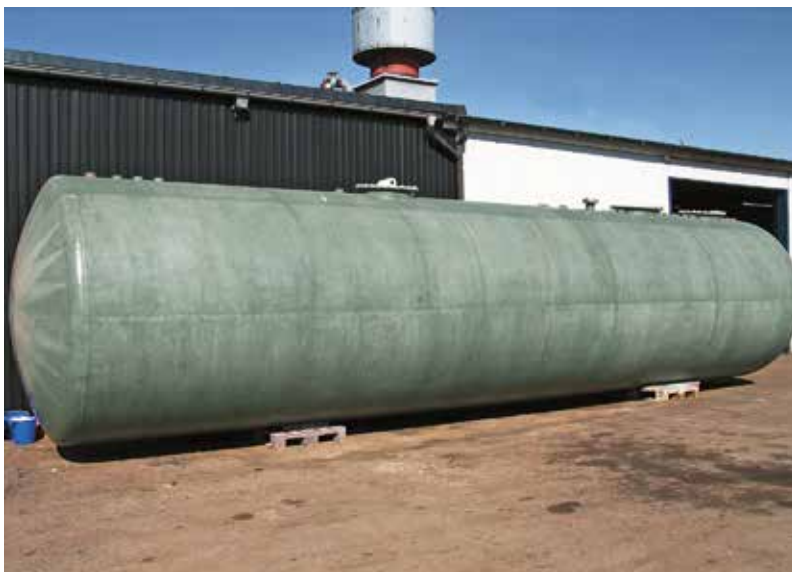
Tillverkningskontrollerad cistern klar för installation
