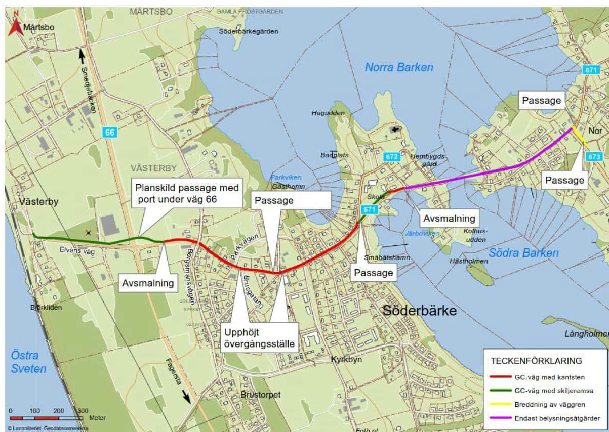
Figur 2.3:2 Planerad utformning enligt vägplan Väg 671 Söderbärke, ny gång- och cykelväg. Källa: Väg 671 Trafiksäkerhetsåtgärder Söderbärke – Planbeskrivning, 2021-02-12.
